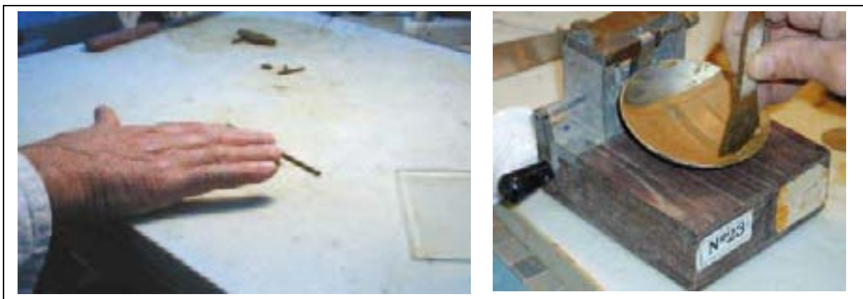
FIGURE 17 : CONFECTION DU BOUDIN PERMETTANT DE DÉTERMINER LA LIMITE DE PLASTICITÉ (À GAUCHE) ET RÉALISATION DE LA RAINURE AVANT LA SÉRIE DE COUPS POUR LA DÉTERMINATION DE LA LIMITE DE LIQUIDITÉ À LA COUPELLE DE CASAGRANDE (À DROITE)
