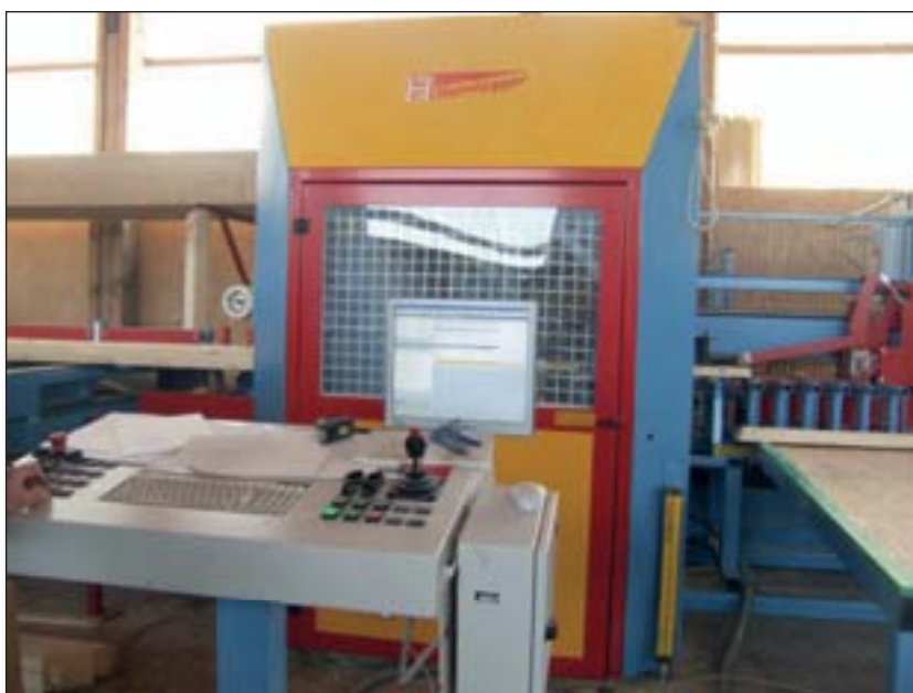
Illustration 28 : Cabine de taillage d'un centre numérique de débit « Hundegger »
