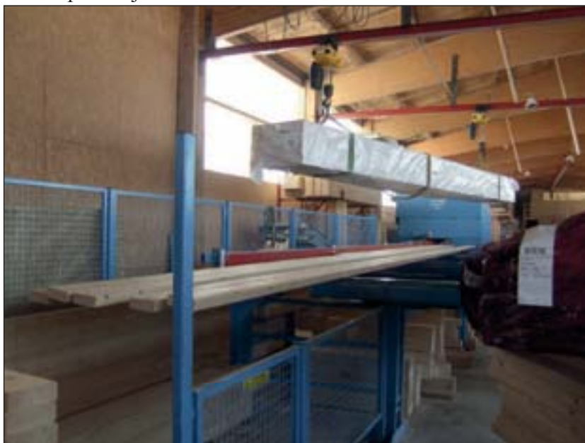
Illustration 27 : Ligne de chargement d'un centre de débit « Hundegger »
