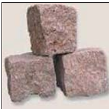
Figure 25 : Porphyre rose, pavés en pierre naturelle, clivés, pavage
